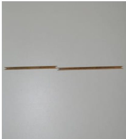
Figura 20 - Corte Desalinhado, Corte Horizontal
