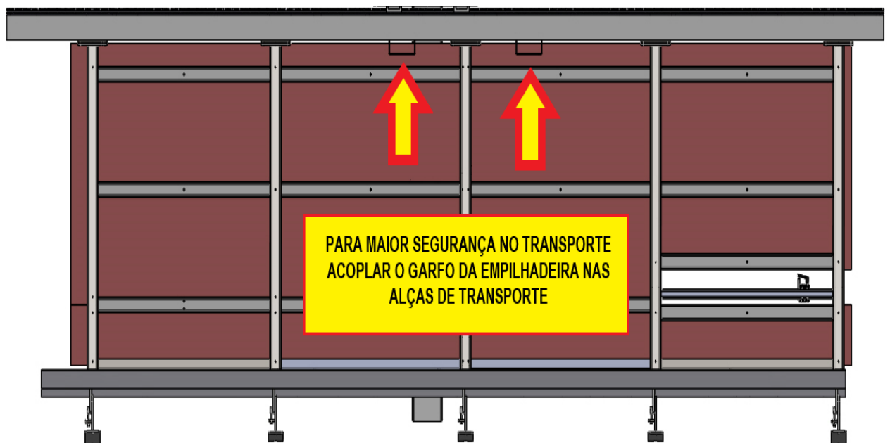
Figura 3 – Ponto de içamento do chassi
