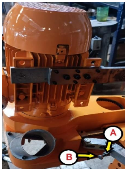
Figura 17 - Regulagem profundidade do Corte
