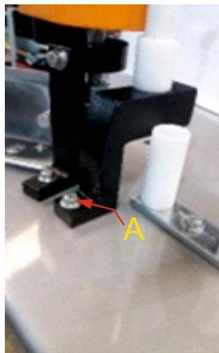
Figura 3 - Fixando o destopador
