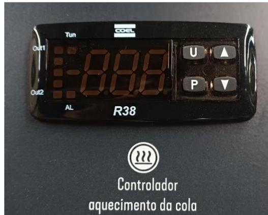
Figura 15 - Controlador de temperatura Coel R38
