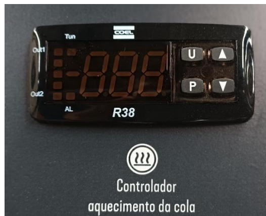
Figura 21 - Controlador de temperatura Coel R38
