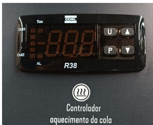
Figura 16 - Controlador de temperatura Coel R38
