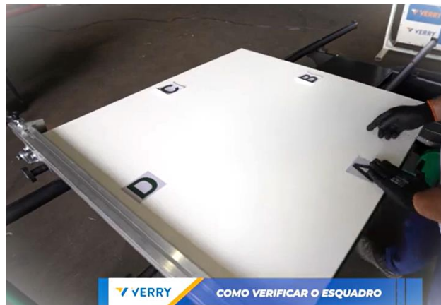
Figura 27 - Procedimento para verificar esquadro
