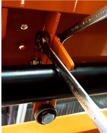
Figura 19 - Travamento do sistema
