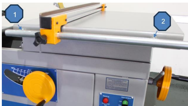
Figura 32 - Instalação do varão de apoio
