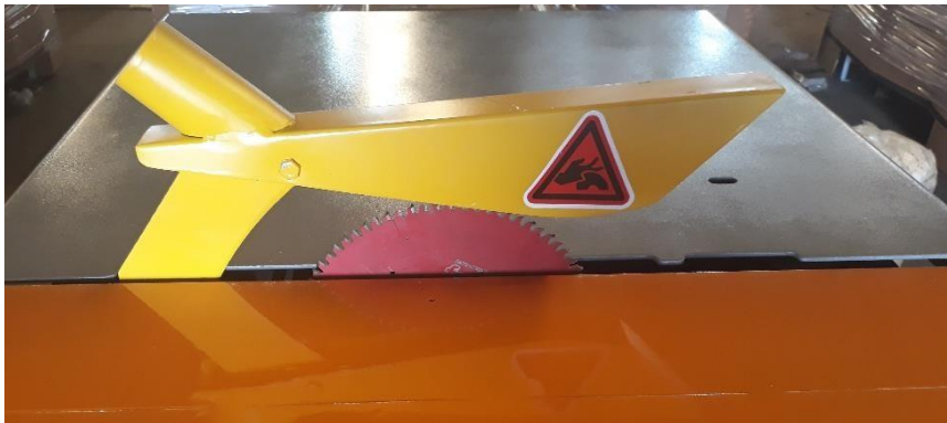
Figura 43 - Rebaixar o riscador
