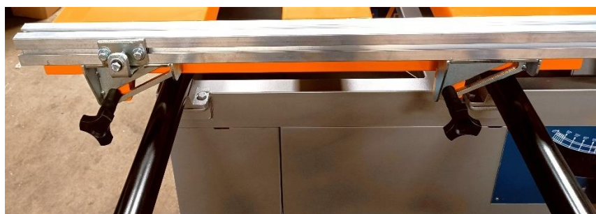
Figura 26 - Instalação do paralelo móvel
