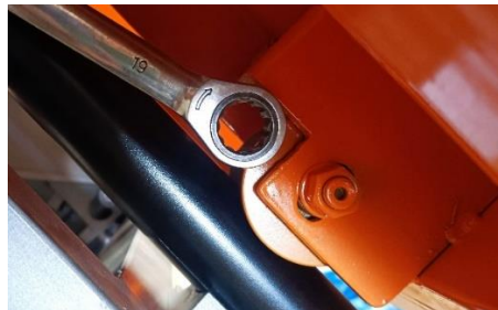
Figura 25 - Regulagem de altura da mesa móvel
