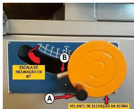
Figura 36 - Regulagem de altura da serra
