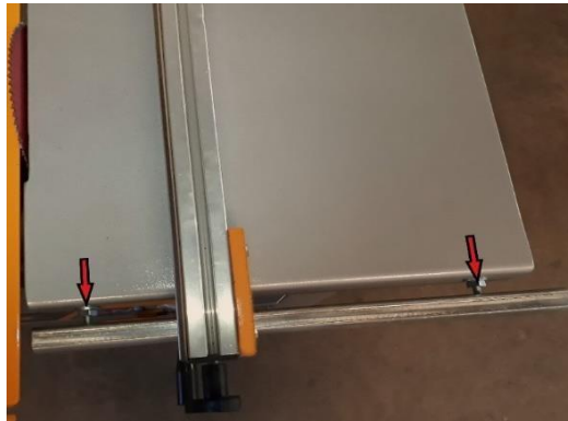
Figura 17 – Regulagem do paralelo da mesa fixa
