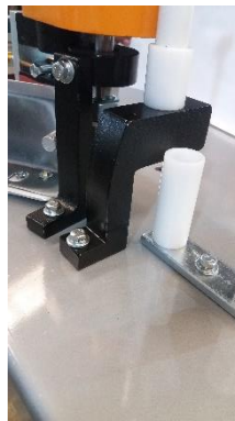
Figura 2 - Instalação do destopador
